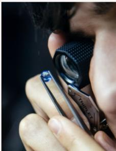
La loupe est l'instrument de base du gemmologue et de tout professionnel de la bijouterie. Il y a loupe et loupe. L'analyse des pierres précieuses nécessite une loupe aplanétique et achromatique de grossissement 10x. L'analyse à la loupe doit précéder toute autre analyse. Elle permet la détection des doublets et l'observation des inclusions. L'analyse à la loupe n'est concluante qu'en de rares occasions et requière une grande expérience en la matière.
